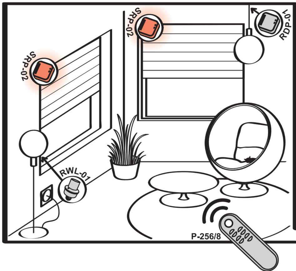
O controlo do sistema de estores é realizado através dos controladores ZMSRP02. Um controlador pode ser usado para um estore. Cada controlador é operado através do comando remoto ZMP256/8 via rádio. O comando remoto pode também controlar a operação do dimmer rádio ZMRDP01 (controlo ligar / desligar e aumentar / diminuir a luminosidade - dimmer) de um circuito iluminação.
